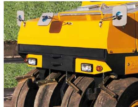
Front-, Heck-, Seitenspiegel. Abhebbare, verschleissarme Abstreifer. Rétroviseurs avant, arrière et latéraux. Racleurs relevables à faible usure.
