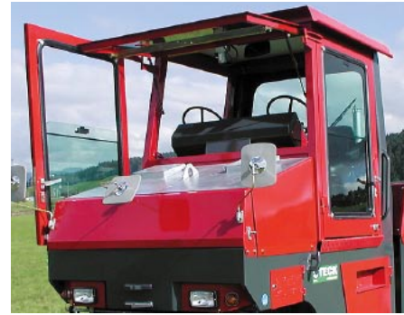
Aufklappbare Kabinenfrontscheibe und 180° schwenkbare Türen mit Arretierung. Pare-brise de la cabine relevable et portes basculables de 180° avec arrêt.
