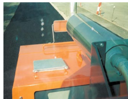
Grosse Wassertanköffnung und seitliche Storzkupplung. Grand orifices de réservoir d'eau et raccord Storz latéral.
